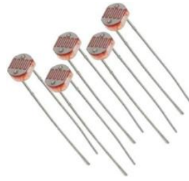
ภาพที่ 2 เซนเซอร์ LDR ที่ใช้ในการทดลอง
