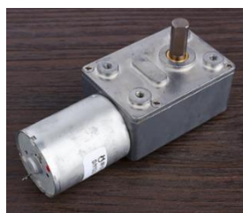
ภาพที่ 8 มอเตอร์เกียร์ดีซี (Motor gear DC)
