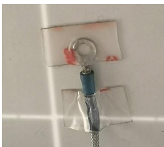
ภาพที่ 4 แสดงเซนเซอร์เทอร์โมคัปเปิลที่นำใช้วัดอุณหภูมิแผงเซลล์แสงอาทิตย์
