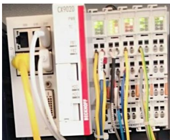
ภาพที่ 2 แสดงพีแอลซีแบบ Embedded PCs ยี่ห้อ Beckhoff ที่ร่วมกับการติดตั้งสัญญาณ
