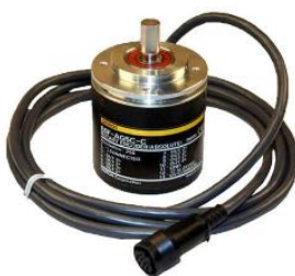
ภาพที่ 7 แสดงเอ็นโค้ดเดอร์ที่นำมาใช้วัดความเร็วรอบของเครื่องกำเนิดไฟฟ้ากระแสสลับ
