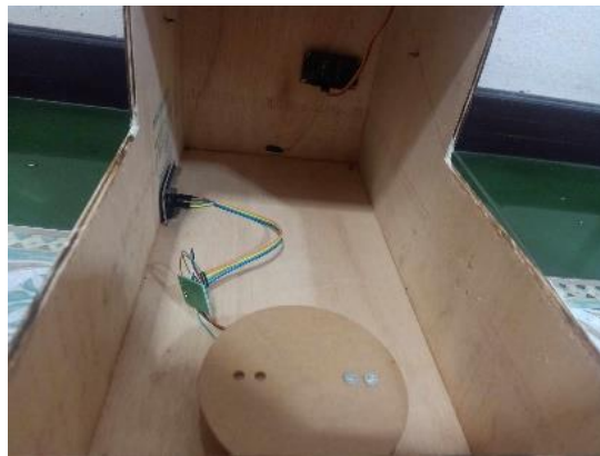
ภาพที่ 5 ตำแหน่งการติดตั้ง HX711 ที่ใช้ทำหน้าที่ชั่งปริมาณน้ำหนักในถ้วยอาหาร หากอาหารน้อยไป เซนเซอร์จะทำหน้าที่ส่งข้อมูลไปที่ Line Notify และหากอาหารมากเกินไป เซนเซอร์ก็จะทำหน้าที่ส่งข้อมูลไปที่ Line Notify เช่นกัน
