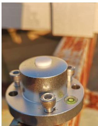
ภาพที่ 6 แสดงเซนเซอร์วัดความเข้มแสงที่นำมาใช้วัดรังสีดวงอาทิตย์ที่ตกกระทบแผงเซลล์แสงอาทิตย์
