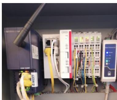
ภาพที่ 3 แสดงอุปกรณ์อินเทอร์เน็ตในทุกสรรพสิ่ง ติดตั้งการรับสัญญาณ Wifi และต่อร่วมเข้ากับ PLC Beckhoff
